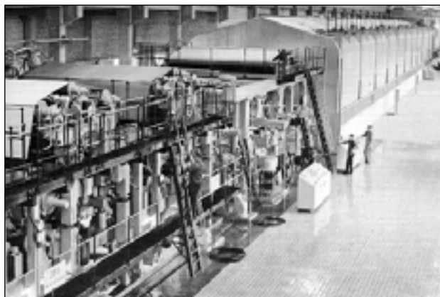
Kartongmaskin 1 hösten 1963. På bilden ses två av våtpartiets övervivor, presspartiet med fyra pressar och torkpartiet.
