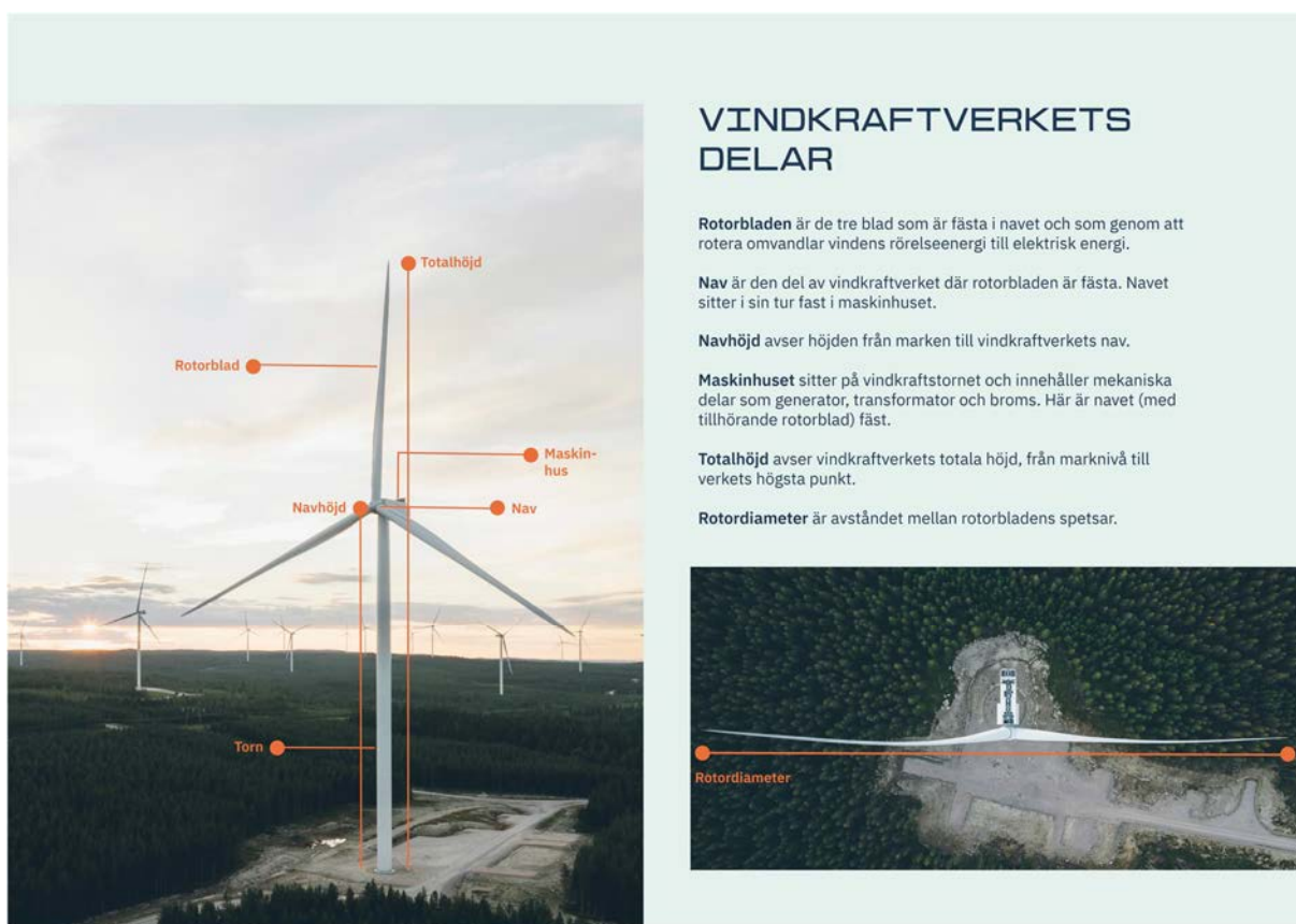
Figur 15. Bild på vindkraftverkets olika delar. Figurkälla: Holmen.
